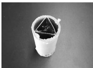
写真②アルミ板を入れる
